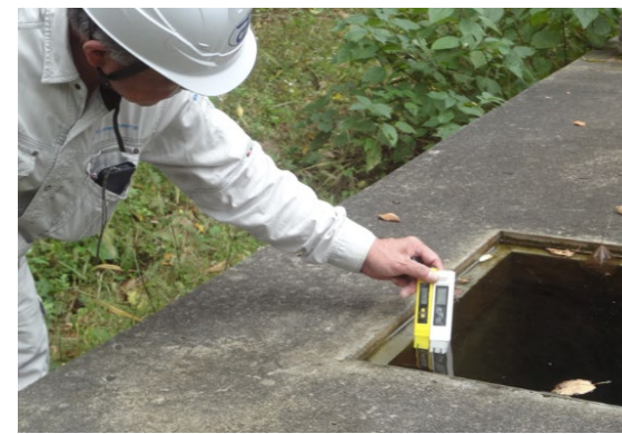
⑤ 浸出水調整槽の埋没内部pHとECの確認
